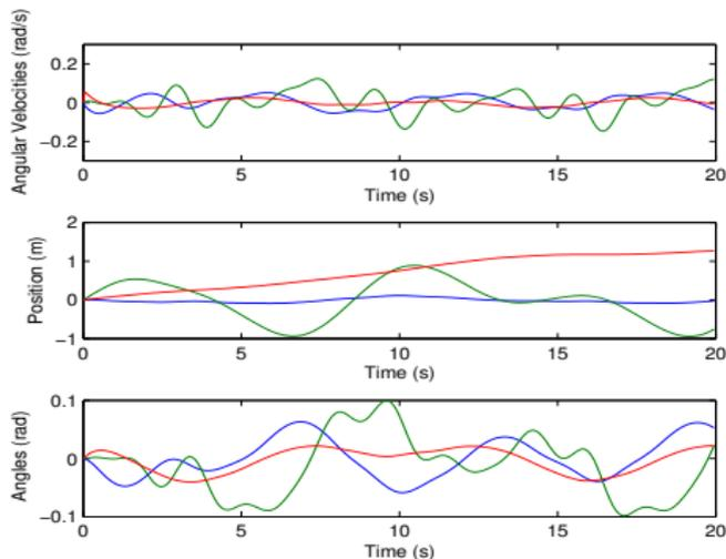
⇒ La condition de persistance d'excitation est nécessaire pour garantir l'observabilité du système (pour avoir  $p$ ,  $q$ ,  $r$  différents de zero).
